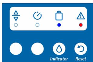
L'appareil ne détecte pas le contenu d'une bouteille. Lors d'une remise à zéro, un compteur interne de la pompe indicatrice est remis à zéro, qui compte alors à rebours à partir de 500 ml. Le compteur ne peut être remis à zéro qu'à un niveau de remplissage de 100 %. Si la combinaison de touches est actionnée pendant le fonctionnement sans qu'une nouvelle bouteille pleine soit insérée, l'alimentation de
