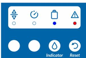
Das Gerät erkennt nicht den Inhalt einer Flasche. Mit einem Reset wird ein interner Zähler der Indikatorpumpe zurückgesetzt, der dann wiederbeginnd bei 500 ml rückwärts zählt. Der Zähler kann nur auf 100% Füllstand zurückgesetzt werden. Wird die Tastenkombination während des Betriebes betätigt, ohne dass eine neue volle Flasche eingesetzt wurde, wird der Indikatorvorrat nicht genau berechnet,
