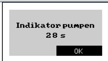
Es wird Indikator in die Messkammer gepumpt.
