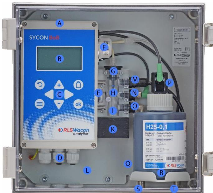
Abbildung 2: Analysengerät SYCON BoB mit eingesetzter Indikator-Flasche
