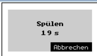
Das Magnetventil öffnet und spült die Messkammer. Dabei wird die bisher vergangene Spülzeit im Display angezeigt. Diese kann als Referenzzeit genutzt werden, um die Spülzeit vor einer Analyse einzustellen. Der Spülvorgang wird mit der [OK]-Taste beendet. Das Magnetventil schließt.
