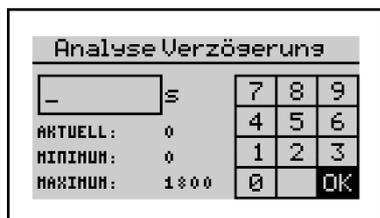
Geben Sie die Verzögerungszeit in Sekunden ein, die vor einer Analyse gewartet werden soll, bevor die Analyse beginnt und das Magnetventil geöffnet wird.
