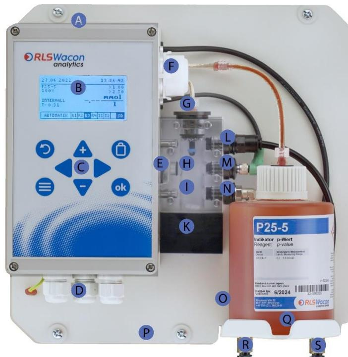
Abbildung 22: Analysegerät SYCON P mit eingesetzter Indikator-Flasche
