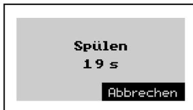
Das Magnetventil öffnet und spült die Messkammer. Dabei wird die bisher vergangene Spülzeit im Display angezeigt. Diese kann als Referenzzeit genutzt werden, um die Spülzeit vor einer Analyse einzustellen.
