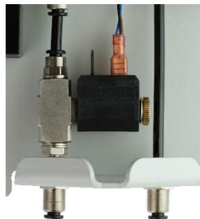
Abbildung 3: Ansicht des Magnetventils (keine Indikatorflasche installiert)
