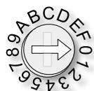
Nach der 3. Betätigung der Taste „Start“ wird der Drehschalter „Spüldauer“ geprüft. Drehen Sie den Schalter nacheinander in die 16 Positionen von 0 bis F. In jeder Position wird eine LED-Kombination entsprechend dem HEX-Code angezeigt.
